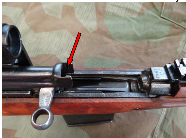
Zdjęcie 3. Zamek w tylnym położeniu. Karabin gotowy do załadunku. Na pokrywie widać wycięcie do włożenia łódki z nabojami.
