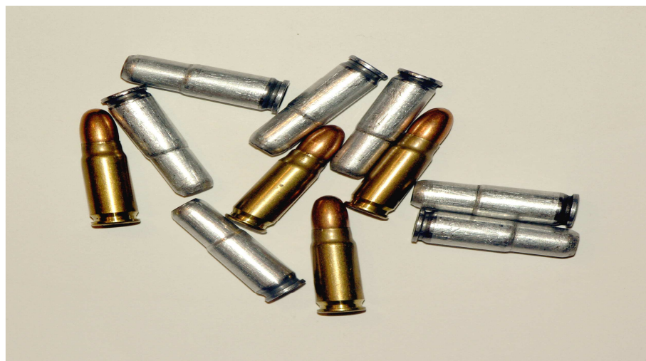
Wkładki nabojoye do Pistoletu Sportowego wz. 33 oraz amunicja 7,62 x 25 mm z 1953 r. produkcji „Mesko” do Pistoletu Wojskowego wz. 33. Fot. autor
